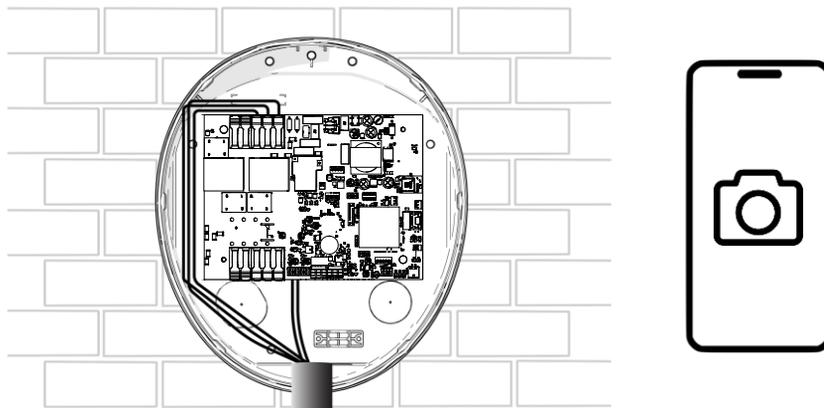
Una vez que haya tomado una imagen, cierre la tapa del cargador, asegurándose de que el interruptor de detección de manipulación (si está instalado) en la parte superior del cargador esté correctamente accionado.
