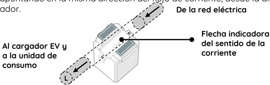
La pinza CT debe cablearse con un cable apantallado Defence Standard de 2 hilos.
