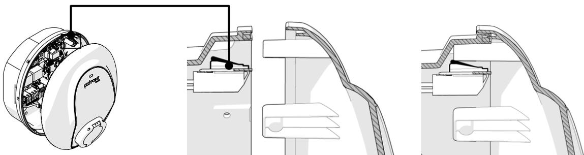
Aplice sellador en el punto de entrada del cable de Alimentación para garantizar que se mantiene la Clasificación IP del cargador y, a continuación, fije la Carcasa con los 6 tornillos de fijación suministrados.
