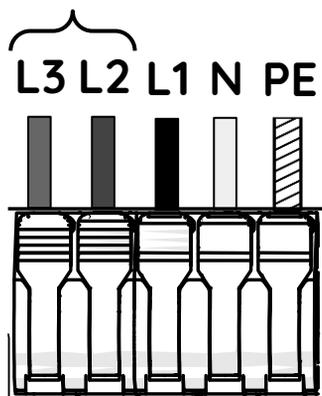
Asegúrese de haber retirado al menos 15 mm de aislamiento del extremo de los cables para permitir un buen contacto con los terminales.
