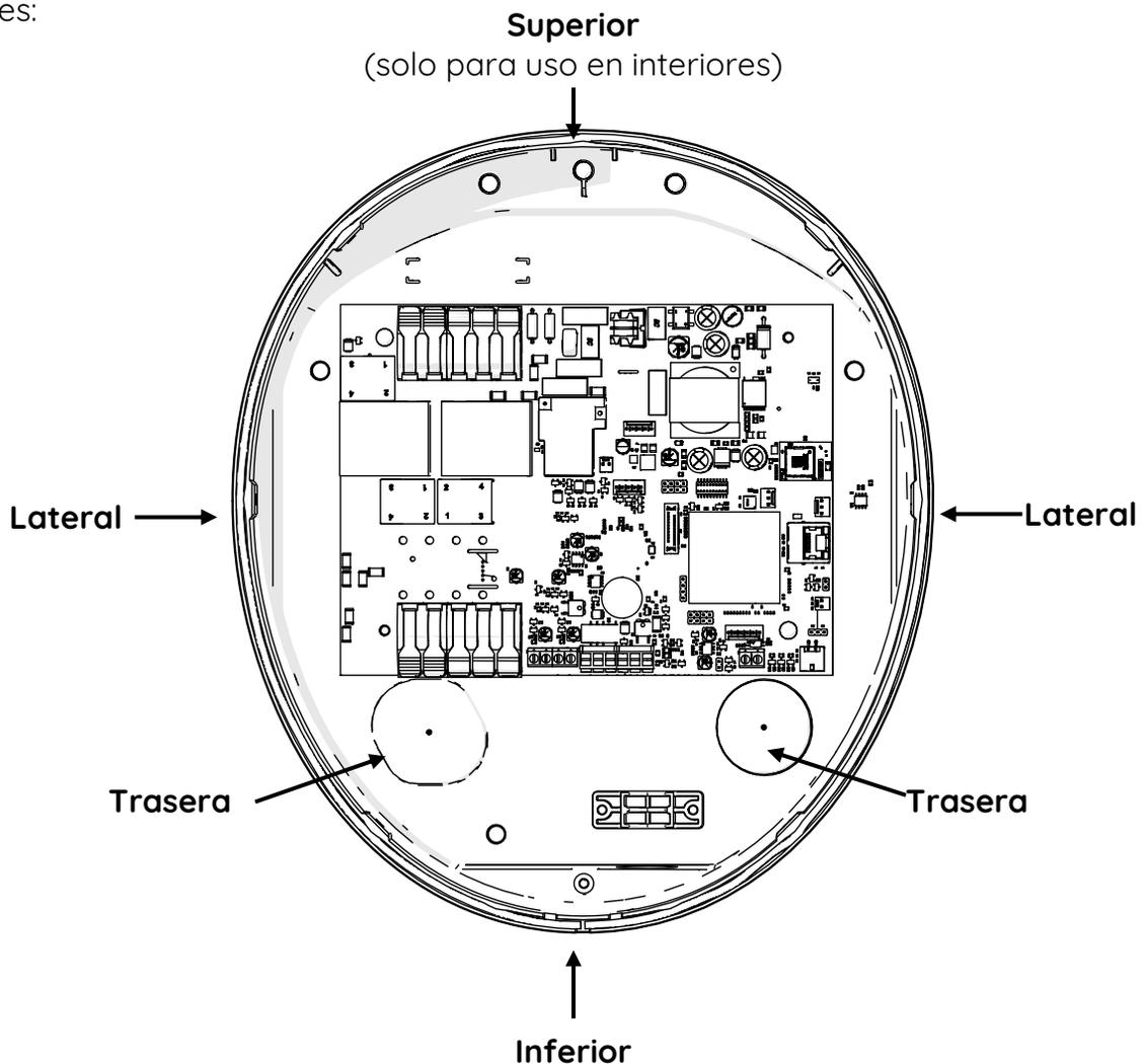
Utilice el punto de entrada superior solo para instalaciones interiores que estén convenientemente alejadas de fuentes de entrada de agua. Tenga cuidado al taladrar para no dañar el cableado o los componentes internos.
