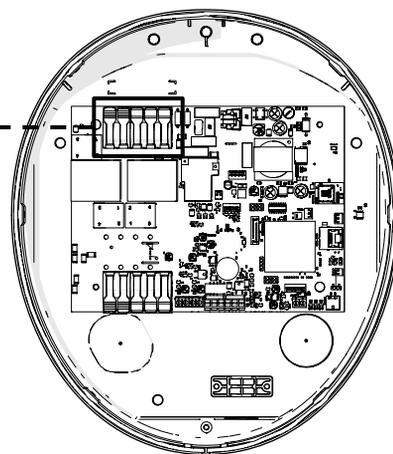
Deje al menos 10 mm de aislamiento interior en la carcasa del Solo 3S para evitar roces con el pasamuros o el SWA.
