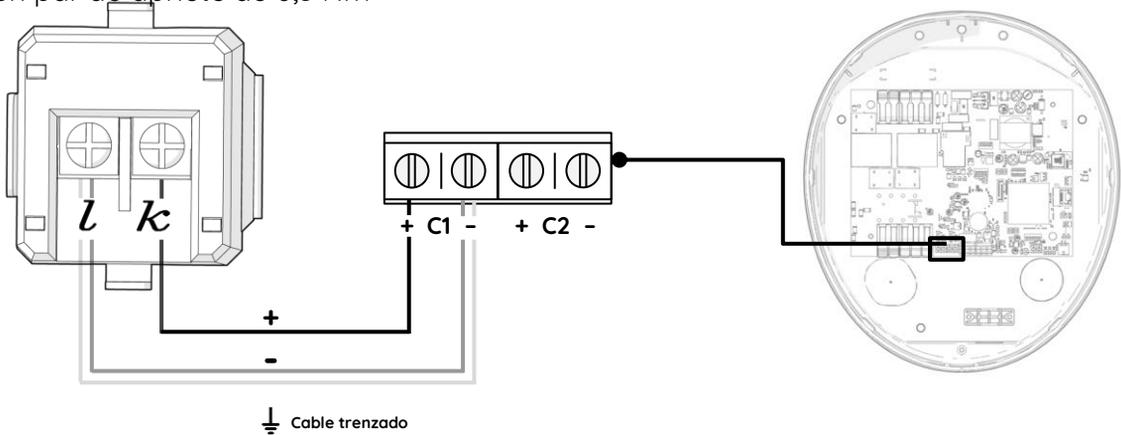
⚠ La abrazadera CT debe fijarse en la posición de sujeción con una brida para cables.
