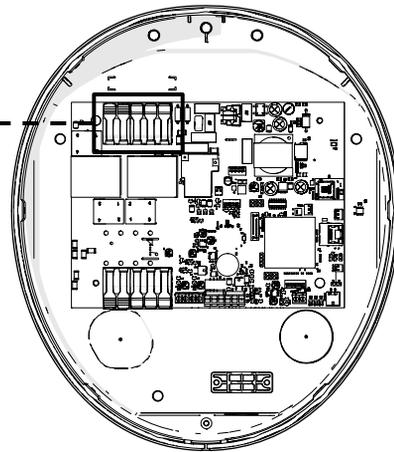
Assurez-vous qu'au moins 15 mm d'isolation ont été retirés de l'extrémité des câbles pour permettre un bon contact avec les connecteurs.
