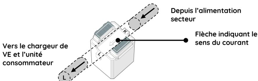
La pince ampèremétrique doit être câblée à l'aide d'un câble blindé de défense standard à 2 conducteurs. L'utilisation de sertissages et de bagues n'est pas nécessaire, la connexion directe du câble de défense standard dans les bornes est suffisante. Relier la pince ampèremétrique au chargeur comme illustré à un couple de 0,5 Nm :
