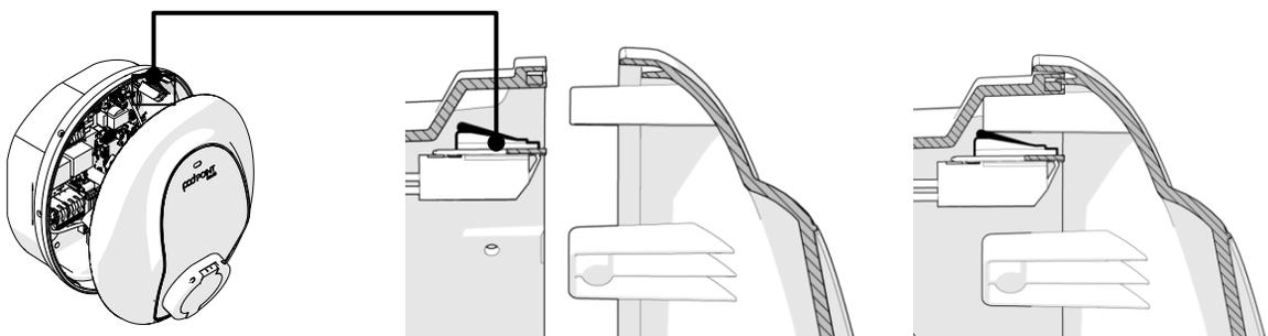
Appliquez un mastic d'étanchéité sur le point d'entrée du câble d'alimentation pour vous assurer que l'indice IP du chargeur est maintenu puis sécurisez le boîtier à l'aide des 6 vis de fixation fournies.
