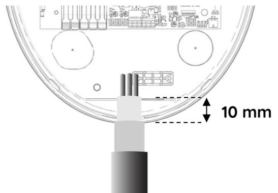
**⚠ Prévoyez une longueur de câble d'alimentation adéquate pour un raccordement facile et évitez toute tension sur les câbles ou le circuit imprimé. Ne pas faire passer les câbles au-dessus de la du circuit imprimé.**
