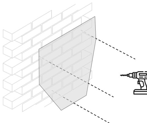
**⚠ Ne pas utiliser le chargeur comme guide de perçage car la poussière de maçonnerie endommagerait les composants internes.**
