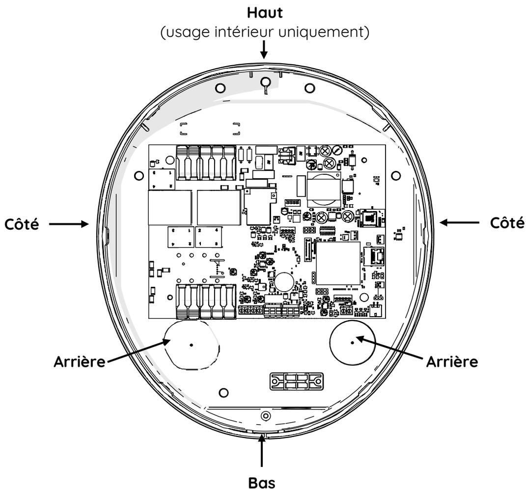
N'utilisez le point d'entrée supérieur que pour les installations en intérieur suffisamment éloignées des sources d'entrée d'eau. Lors du perçage, veuillez à ne pas endommager le câblage interne ou les composants.
