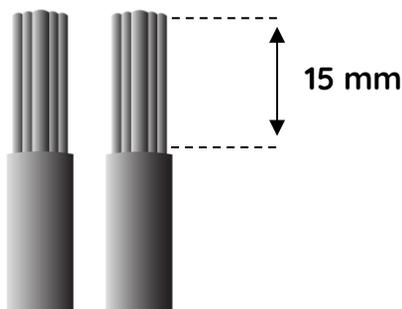
Laissez au moins 10 mm d'isolation intérieure pénétrer dans le boîtier du Solo 3S pour éviter les frottements avec le presse-étoupe ou le câble armé.
