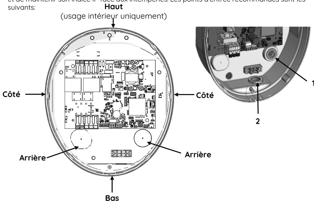
N'utilisez le point d'entrée supérieur que pour les installations en intérieur suffisamment éloignées des sources d'entrée d'eau. Lors du perçage, veillez à ne pas endommager le câblage interne ou les composants.
