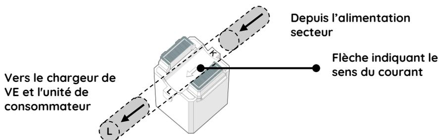
**Le tore de mesure doit être câblé à l'aide d'un câble blindé standard à 2 conducteurs.**
